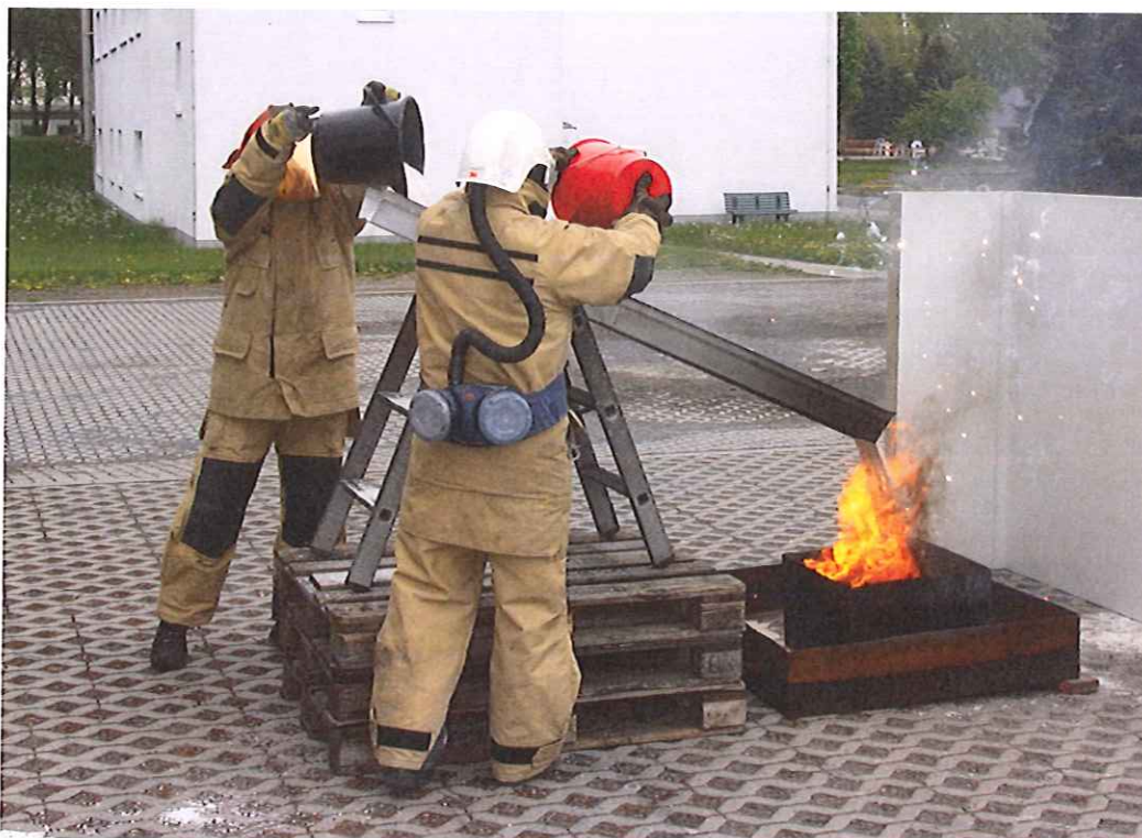
Abb. 6: Aufbringen von EXTOVER auf das Brandobjekt nach Wegnahme des Zündinitials
