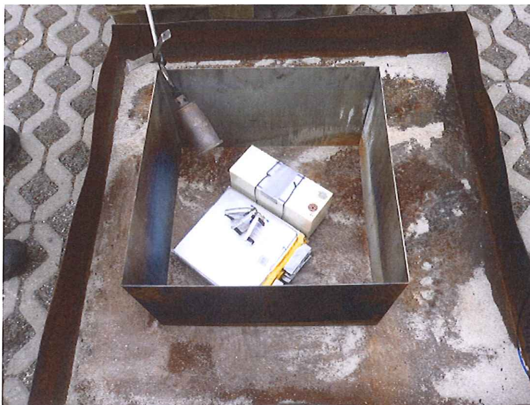
Abb. 2: Lithium-Primärbatterie und Lithium-Batterie aus Pouchzellen bestehend vor Zündung
