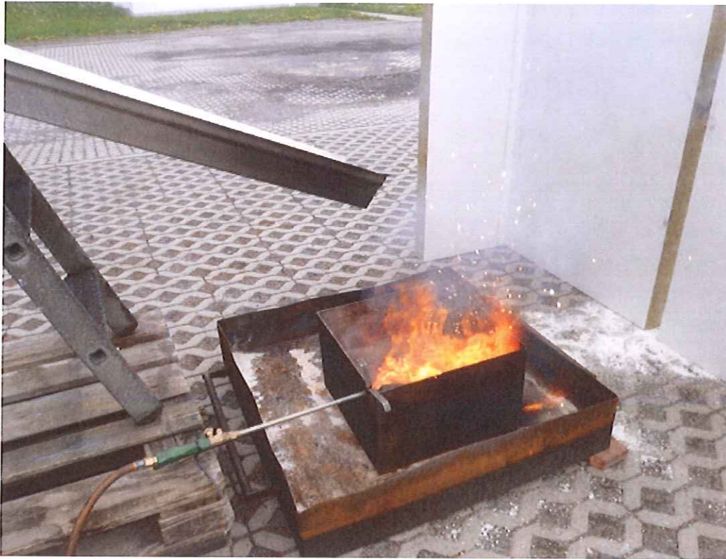
Abb. 5: Anzeichen auf selbstständiges Brennen der Batterien (Funkenflug, kleine Verpuffung)
