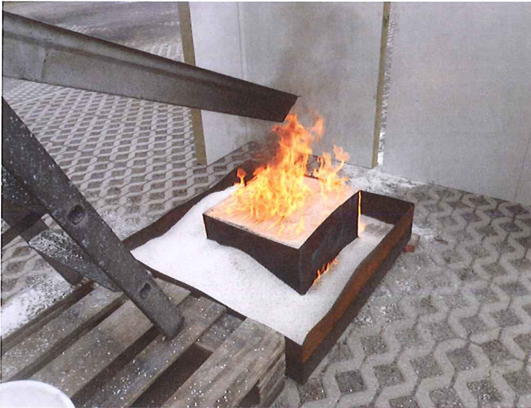
Abb. 6: Zustand des Brandobjektes nach Abdeckung mit EXTOVER
