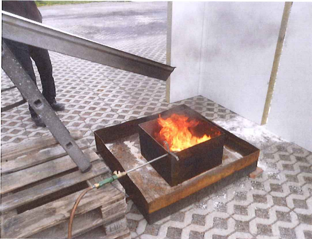
Abb. 3: Zündung der Batterien mittels Grün-Starkbrenner St 65 (120 kW)
