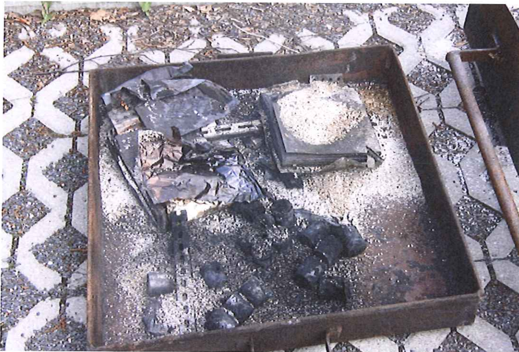
Abb. 9: Zustand der Probekörper nach Entfernung von EXTOVER
